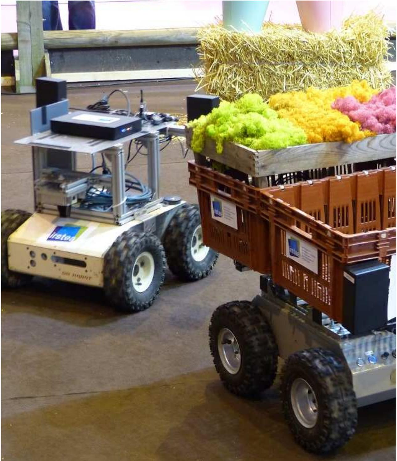
***Irstea démontre les performances du robot Effibot, un robot porteur chargé de transporter du matériel ou des produits en suivant automatiquement l'agriculteur pendant la récolte.
