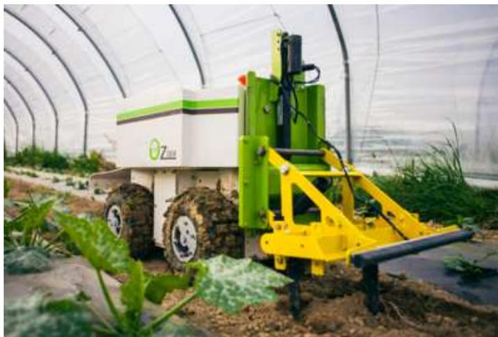
*Grâce à son guidage laser et caméra, le robot Oz se déplace en toute autonomie à travers champs (Crédit : Naïo Technologies)*
